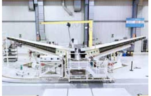
Da im Rumpf und in den Tragflächen Verbundwerkstoffe eingesetzt werden, sind weniger Materialermüdungstests nötig als bei Aluminiumteilen. Verbundwerkstoffe und Titan erfordern zudem deutlich weniger Korrosionstests. Alle drei A350-XWB-Modelle verwenden die gleiche Tragflächenkonstruktion, die hauptsächlich aus Kohlefaser-Verbundmaterialien besteht.
