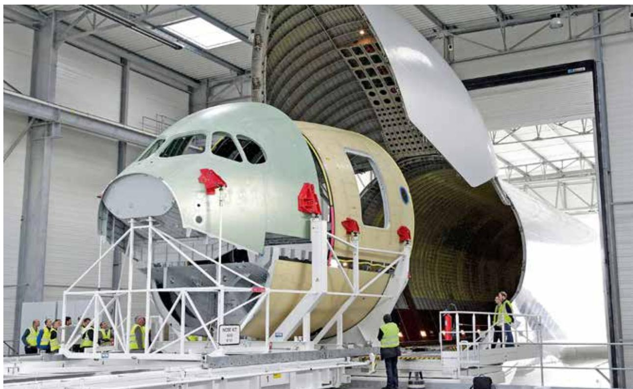
Das erste A350-XWB-Bugsegment wird aus einem Beluga-Transportflugzeug ausgeladen.
