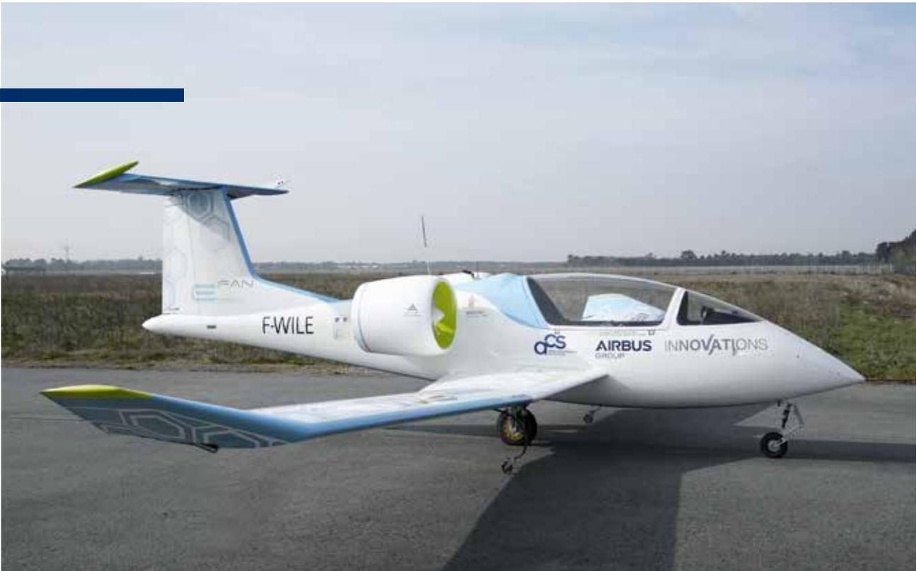
Das elektrisch angetriebene Trainingsflugzeug E-Fan.
