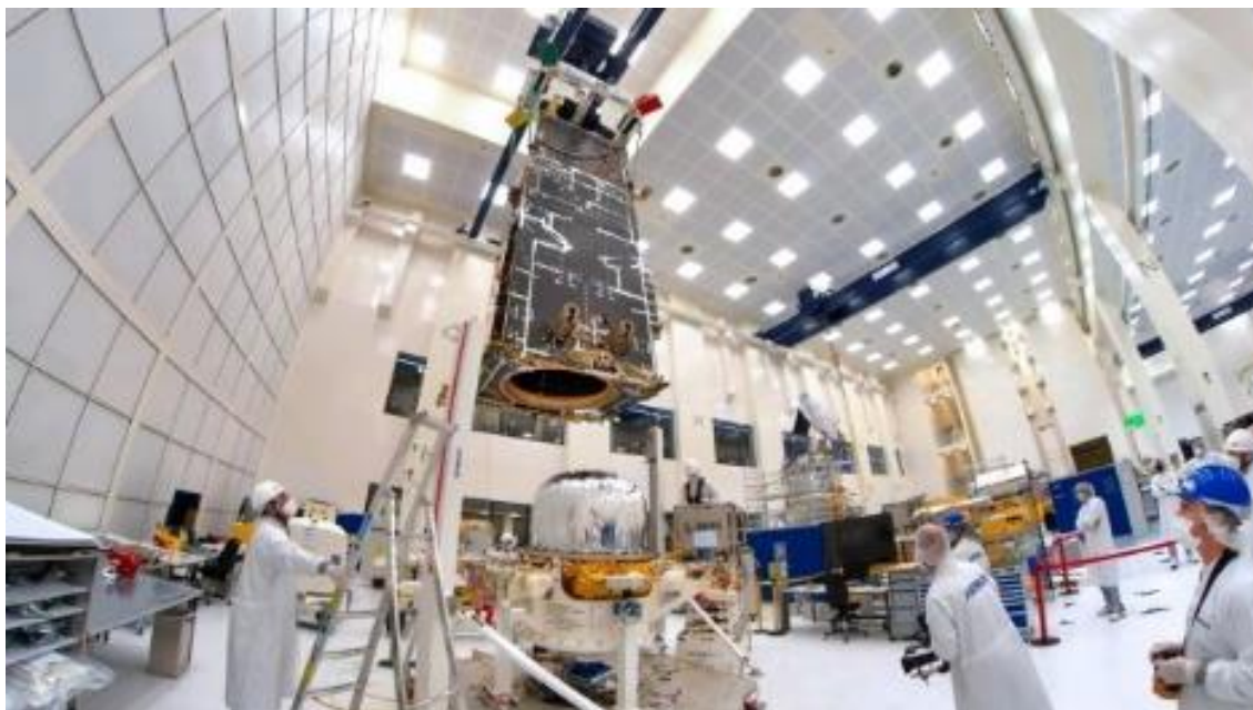
Die Satellitenstruktur MetOp-SG B wird über das Antriebsmodul gehievt. Foto: Airbus / M. Pikelj
