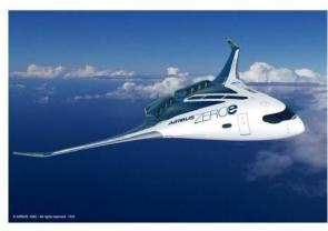
Un concept d'aéronef à fuselage intégré (jusqu'à 200 passagers), dont la voilure se fond dans le fuselage principal de l'appareil et qui présente un rayon d'action comparable à celui du concept de turboréacteur. Le fuselage exceptionnellement large offre de multiples possibilités pour le stockage et la distribution d'hydrogène, ainsi que pour l'aménagement de la cabine.
