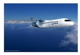
Un concept de turbopropulseur (capable d'embarquer jusqu'à 100 passagers) utilisant un moteur turbopropulseur au lieu d'un turboréacteur, également alimenté par la combustion d'hydrogène dans des turbines à gaz modifiées, et capable de parcourir plus de 1800 km. Une option idéale pour les vols court-courriers.
