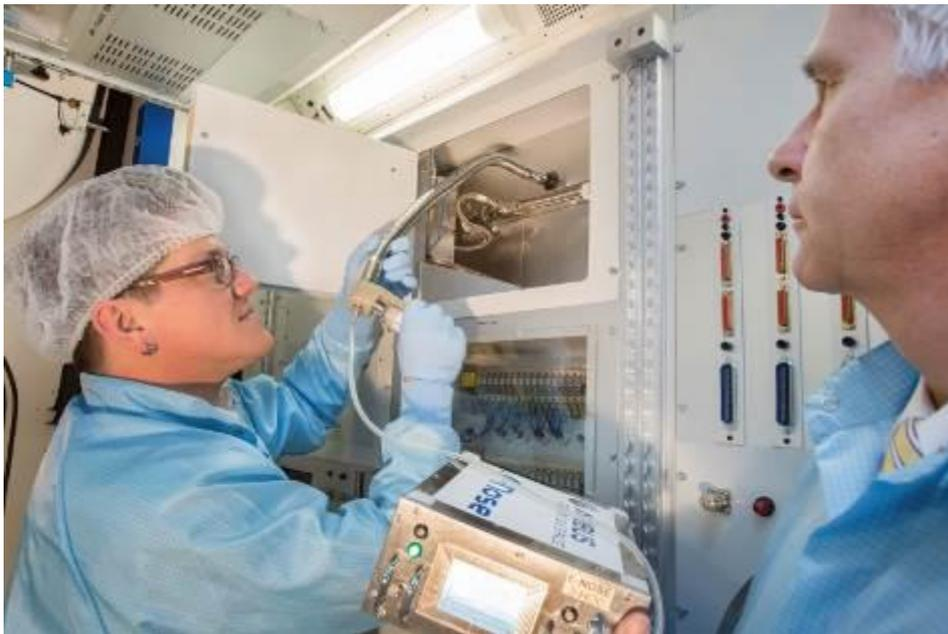
**Viktor Fetter et Thomas Hummel d'Airbus Defence and Space prélèvent des échantillons dans un module de test de l'ISS. Semblable à une trompe, le nouvel instrument de l'E-nose sera capable de détecter les contaminations microbactériennes dans tous les recoins de l'ISS.**
