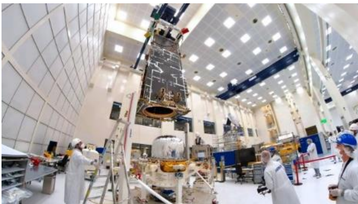
La estructura del satélite MetOp-SG B siendo integrada con el módulo de propulsión. Copyright Airbus – M. Pikelj
