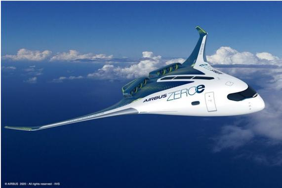
**Un diseño con “cuerpo de ala mixta”** (hasta 200 pasajeros) en el que las alas se fusionan con el cuerpo principal de la aeronave y con un alcance similar al del concepto que utiliza turbofán. El fuselaje, excepcionalmente ancho, permite múltiples opciones para el almacenamiento y distribución del hidrógeno, así como para la configuración de la cabina.
