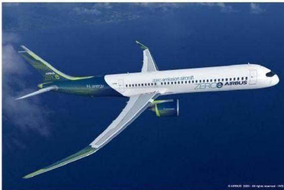
**Un diseño con turbofán** (120-200 pasajeros) con un alcance de más de 2.000 millas náuticas, capaz de realizar operaciones transcontinentales y propulsado por un motor de turbina de gas modificado que funciona por combustión de hidrógeno, en lugar de utilizar combustible de avión. El hidrógeno líquido se almacenará y distribuirá usando tanques ubicados detrás del mamparo presurizado trasero.
