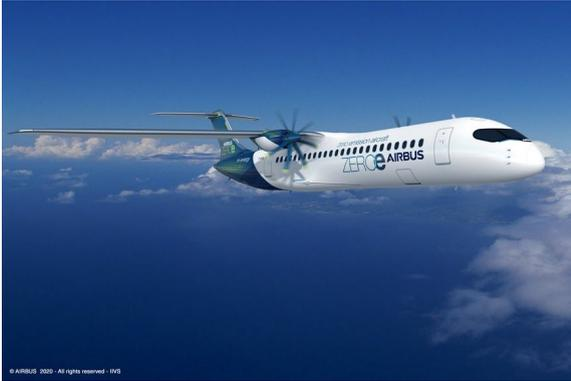
**Un diseño con turbohélice** (hasta 100 pasajeros) que utiliza un motor turbohélice en lugar de turbofán, propulsado también por combustión de hidrógeno en motores de turbina de gas modificados, lo que les permitiría viajar más de 1.000 millas náuticas y ser la opción perfecta para viajes de corta distancia.
