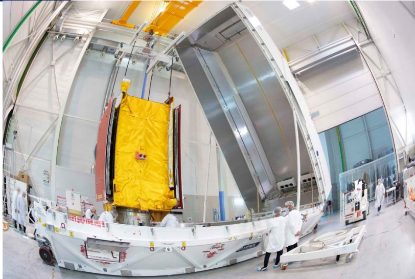
EUTELSAT QUANTUM siendo cargado en el contenedor – Copyright ESA-Manuel Pedoussaut
