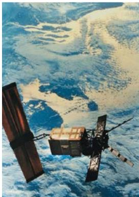
En el núcleo del ERS-1, que operaba en una órbita polar a 785 kilómetros de la Tierra, se encontraba un radar de una longitud de onda de 5,7 centímetros, lo que corresponde a una frecuencia de 5,3 GHz en la banda C. Cada vez que el satélite completaba una órbita alrededor de la Tierra, su haz escaneaba una franja de 4.000 kilómetros de largo por 100 kilómetros de ancho de la superficie de la Tierra. De esta manera era posible generar imágenes con una resolución de 30 metros.
