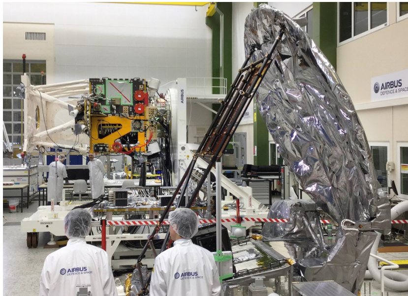
El radar japonés de monitorización de las nubes (a la derecha en primer plano) se integrará en el satélite EarthCARE de la ESA que está desarrollando actualmente Airbus. Foto: Airbus DS GmbH / Mathias Pikelj
