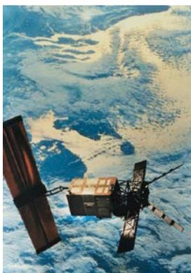
Opérant en orbite polaire, à 785 km d'altitude, ERS-1 était doté d'un radar d'une longueur d'onde de 5,7 cm (ce qui correspond à une fréquence de 5,3 GHz en bande C). À chaque révolution du satellite, son faisceau balayait une bande de 4 000 km de long et de 100 km de large de la surface de la Terre, générant ainsi des images d'une résolution de 30 mètres.
