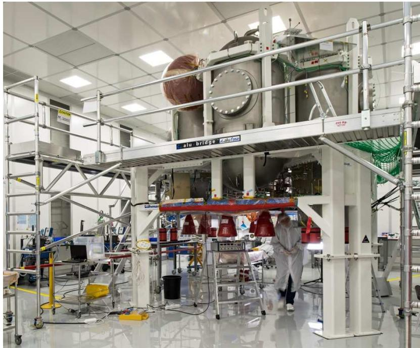
Bremen, 24/01/2017 - A mediados de enero de 2017 Airbus Defence and Space entregó a la NASA un módulo de propulsión experimental para el programa Orion. El modelo de propulsión de ensayos de certificación (PQM, por sus siglas en inglés) se utilizará para comprobar que el subsistema de propulsión del módulo de servicio europeo (ESM, por sus siglas en inglés) de la nave espacial Orion funciona correctamente.
