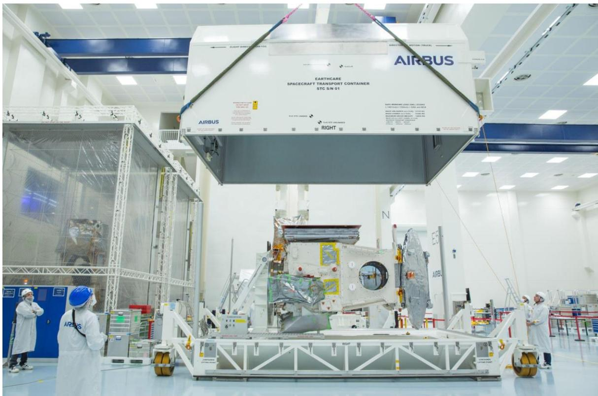
Der EarthCARE-Satellit wird für den Flug zur Startrampe in seinen Container gepackt - Copyright Airbus
