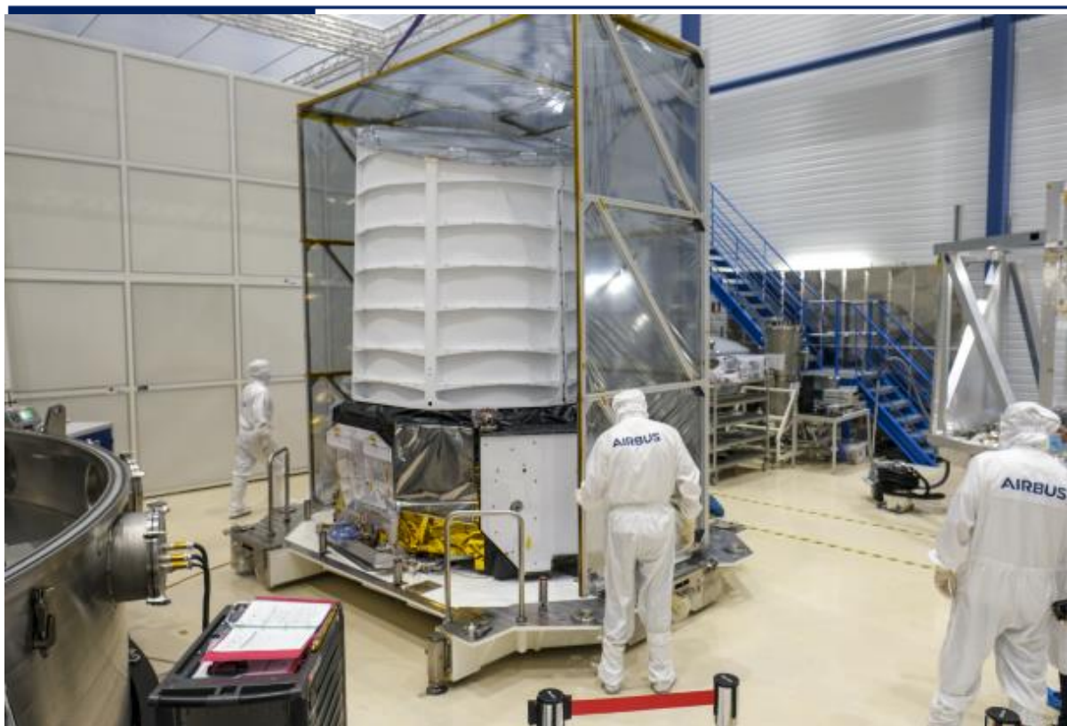
Fabriqué par Airbus, le télescope de la mission Euclid de l'ESA est préparé pour son test en vide thermique - Copyright Airbus -
