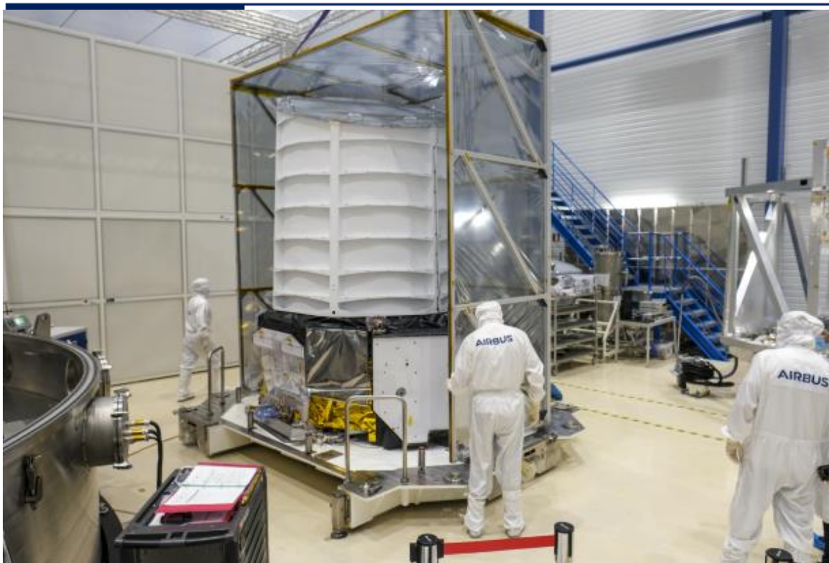
El telescopio construido por Airbus para la misión EUCLID de la ESA en preparación de los ensayos de vacío térmico – Copyright Airbus
