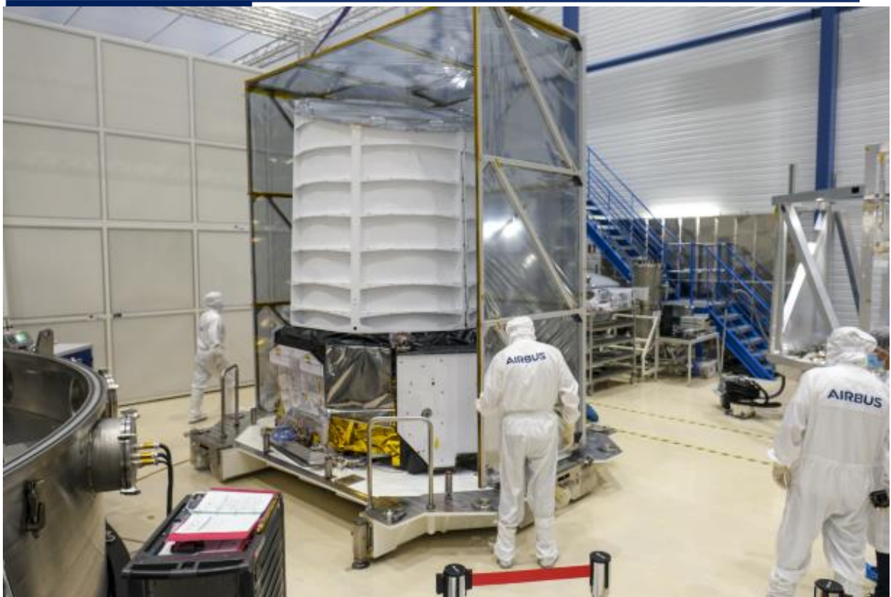
Das von Airbus gebaute Teleskop für die Euclid-Mission der ESA wird für einen thermischen Vakuumtest vorbereitet - Copyright Airbus -
