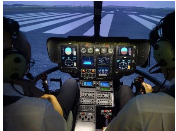
デュアル・コントロール 実物と同じ仕様のコックピット 左席にも操縦装置が装備されているため、 操縦士 2 名が搭乗して訓練可能
