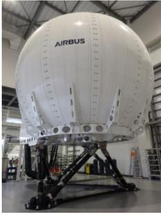
2014年に神戸空港事業所内 トレーニングセンターに導入された H135 P2+のフル・フライト・シミュレーターはエアバス・ヘリコプターズグループ内 EC135 シミュレーターで最高レベルの Level C の仕様です。シミュレーターの活用により、実機では実施することが難しい多様なシステムの非常操作や悪気象条件下の運航、整備士の試運転その他様々なミッションを想定した効率的で低コストの訓練を提供することが可能になりました。
