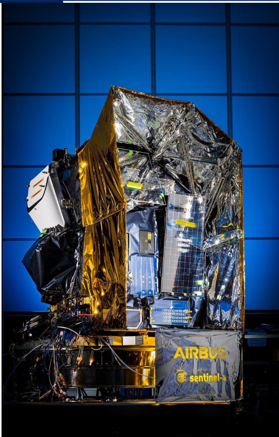
Flugmodell des Luftüberwachungsinstruments Sentinel-4/UVN - Copyright Airbus 2021 Ralf Maurer
