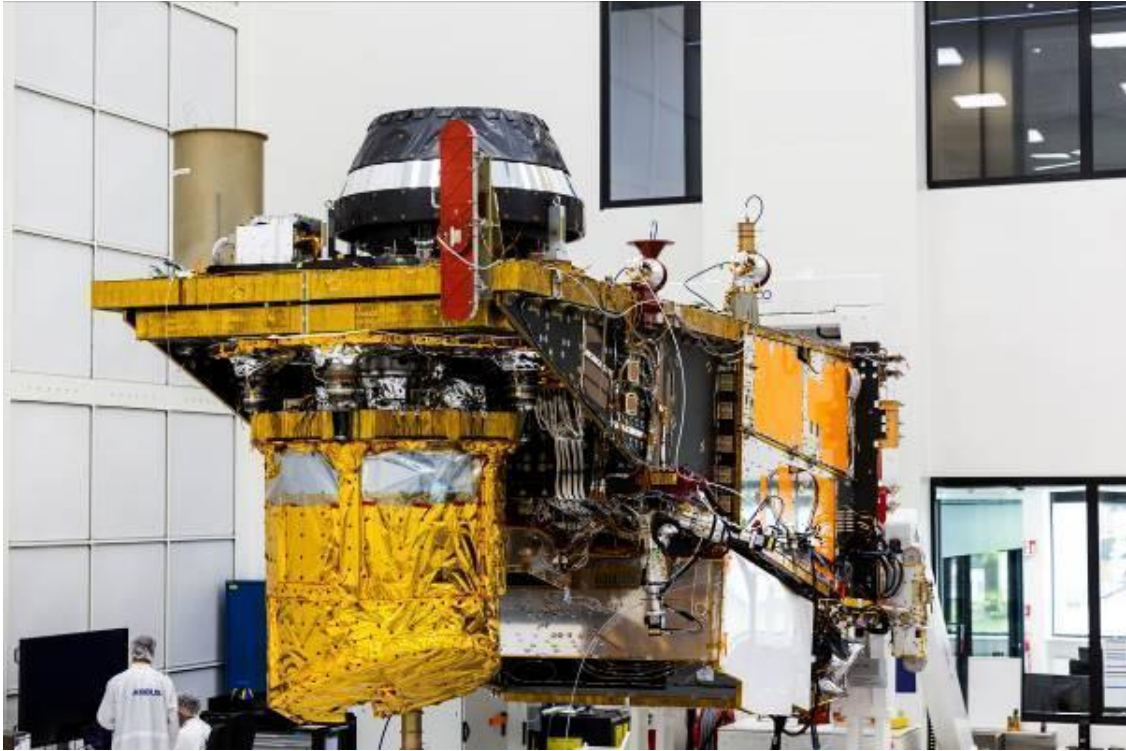
L'instrument d'analyse des nuages -ICI- construit par Airbus et intégré au satellite MetOp-SG-B - Copyright Airbus -
