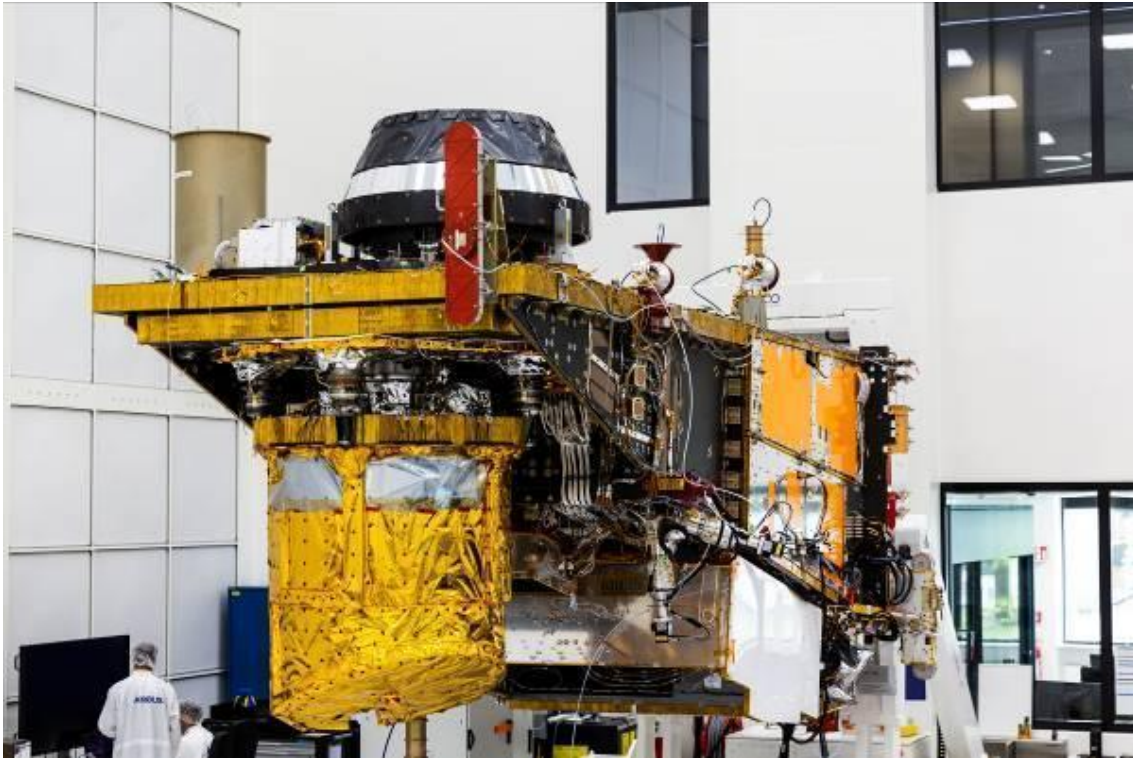
Das von Airbus entwickelte Instrument zur Wolkenanalyse ist auf dem Satelliten MetOp-SG B installiert - Copyright Airbus -
