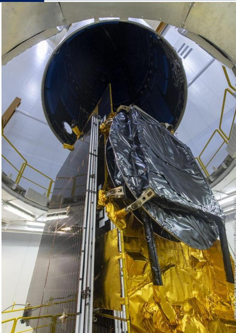
"MEASAT-3d construido por Airbus siendo encapsulado en el lanzador Ariane 5"
