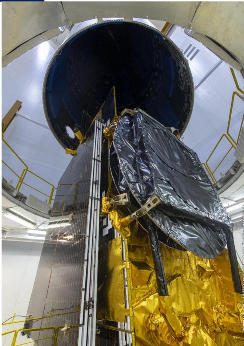
Der von Airbus gebaute Satellit MEASAT 3d wird in die Ariane-5-Trägerrakete eingebaut
