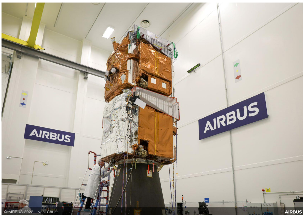
Die beiden letzten Pléiades Neo-Satelliten in ihrer "selbststapelbaren" Konfiguration während mechanischer Tests - Copyright Airbus
