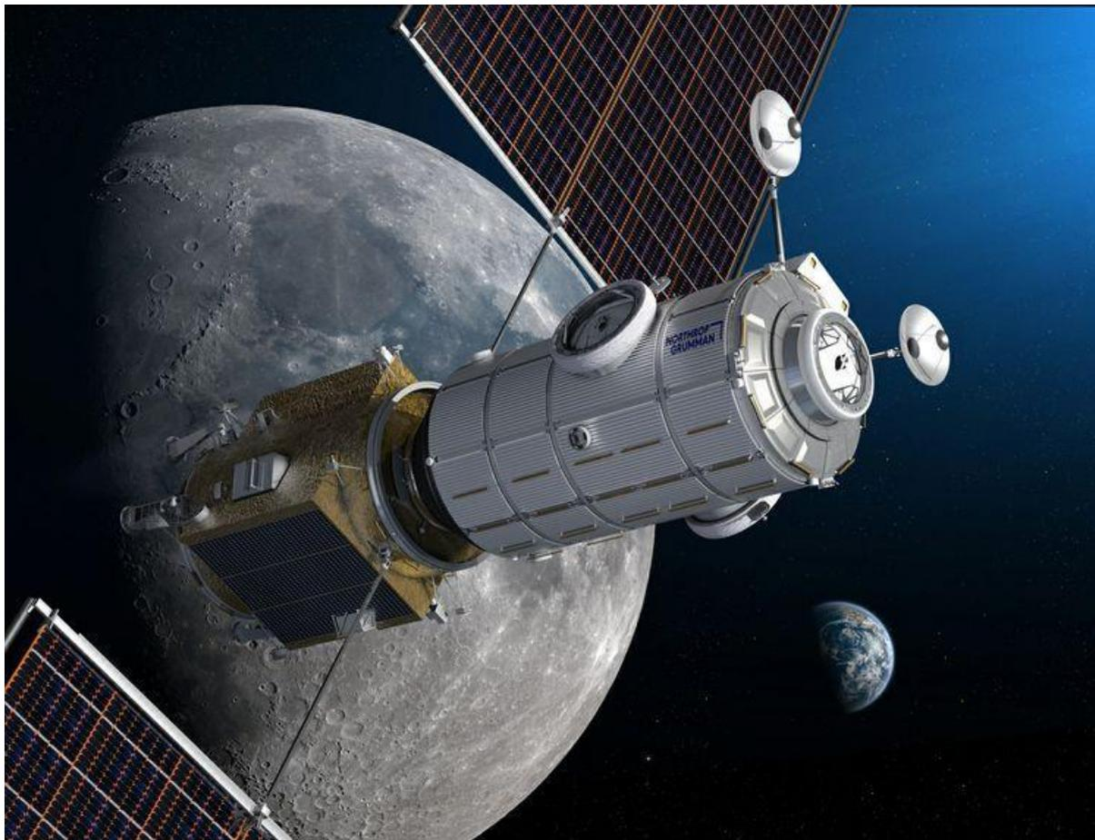
Künstlerische Illustration des HALO-Moduls von Northrop Grumman und des Power Propulsion Elements, die die erste kritische Komponente des NASA-Gateways bilden.
