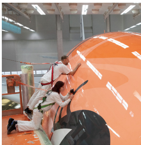
塗装作業中の3号機
