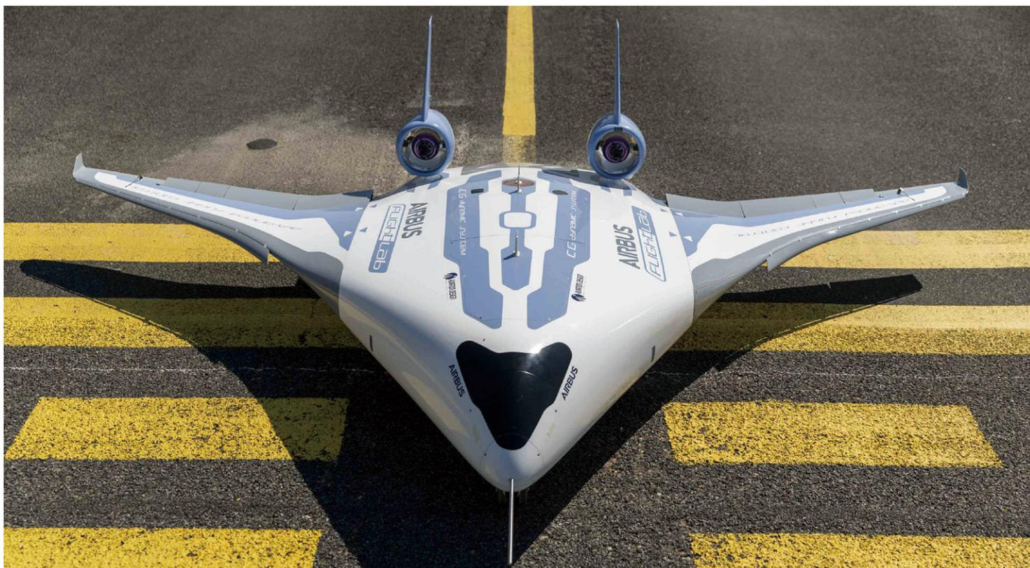
ブレンデッド・ウィング・ボディのスケールモデル実験機
