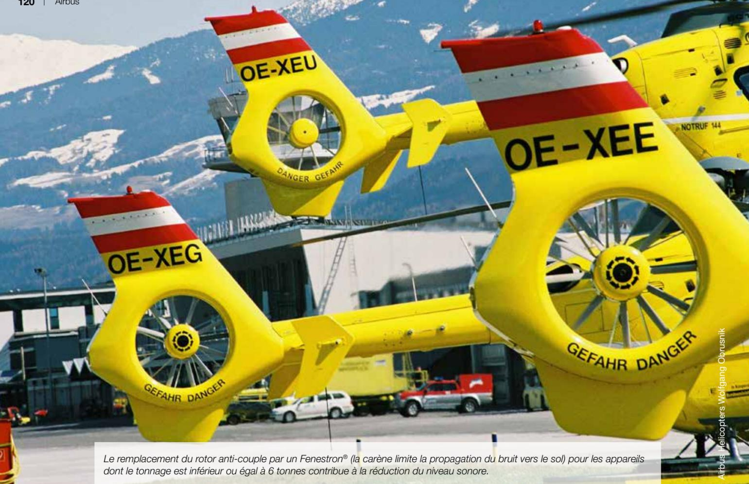
Le remplacement du rotor anti-couple par un Fenestron® (la carène limite la propagation du bruit vers le sol) pour les appareils dont le tonnage est inférieur ou égal à 6 tonnes contribue à la réduction du niveau sonore.
