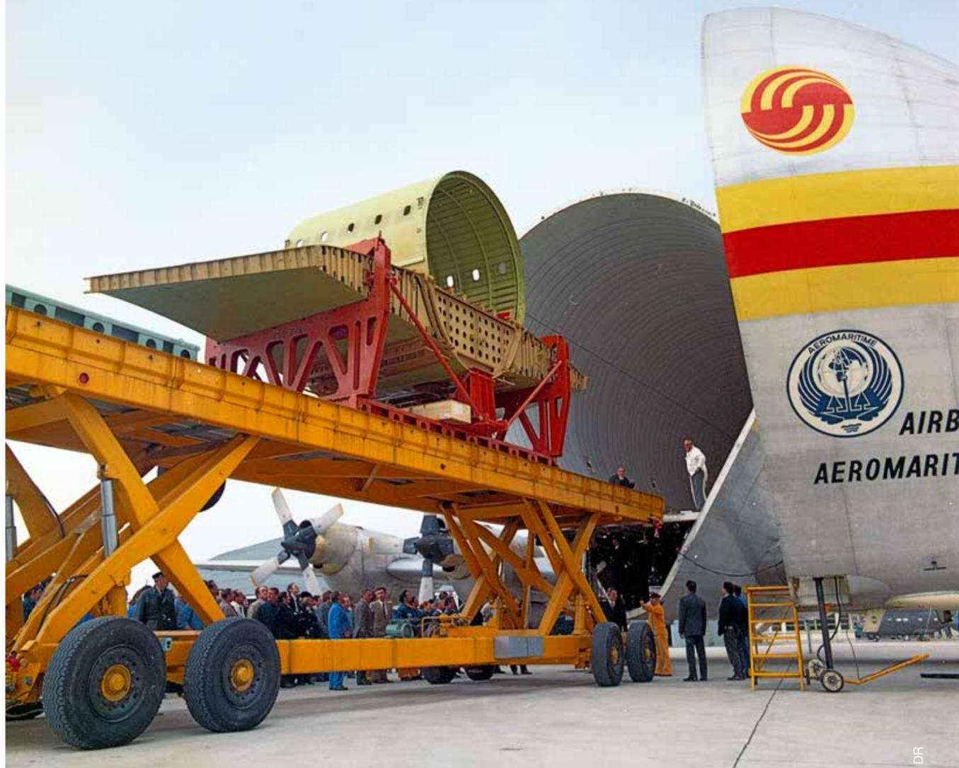
Les tronçons étaient embarqués dans le Super Guppy, spécialement affrété pour cette occasion, pour être acheminés à Toulouse où était implantée la chaîne d'assemblage.
