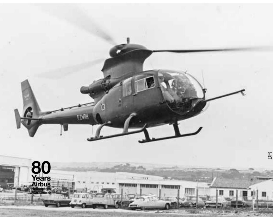
La Gazelle pulvérisé trois records du monde de vitesse : sur base 3 km (310 km/h), sur base 15/25 km (312 km/h) et sur 100 km en circuit fermé (296 km/h). Les modifications apportées pour le record concernaient le rotor principal qui fut enfermé dans un capotage circulaire, appelé oursin, avec un carénage de mât spécifique, étudié en soufflerie.
