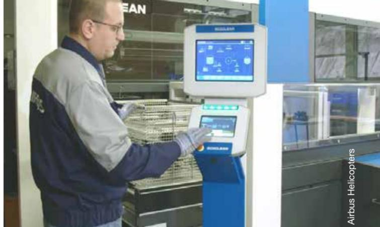
Machine "Eccoclean™" permettant d'éliminer les poussières et résidus d'usinage avant emballage.
