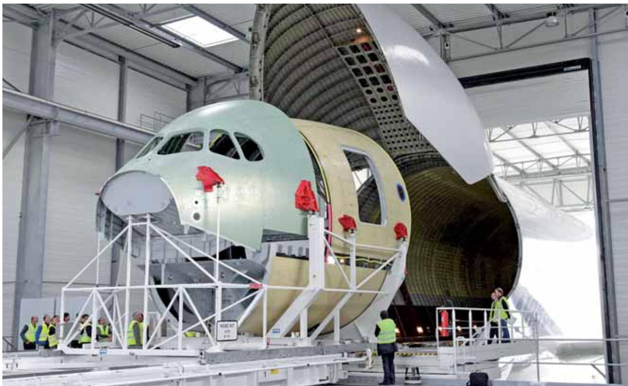
Pointe avant de l'A350 XWB déchargée d'un avion-cargo Beluga.
