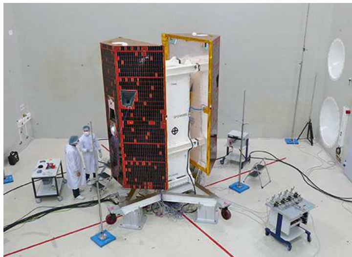
Préparatifs en vue des essais acoustiques des deux satellites GRACE-FO, réalisés par Airbus pour la NASA/JPL. Photo : Airbus DS GmbH / Mathias Pikelj
