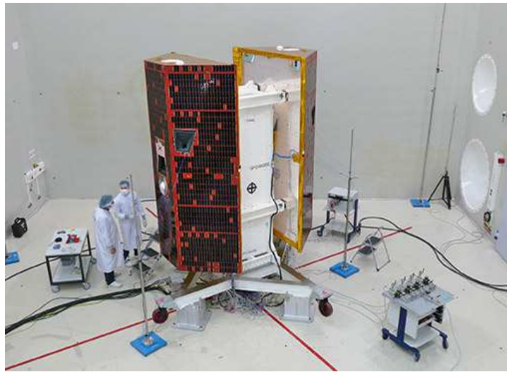
Preparaciones del test de ruido acústico para los dos satélites GRACE-FO que ha construido Airbus para la NASA/JPL. Foto: Airbus DS GmbH / Mathias Pikelj
