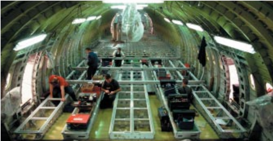
Bildunterschrift: Der Kabinenboden muss ein Gewicht von bis zu 50 Tonnen tragen können.
