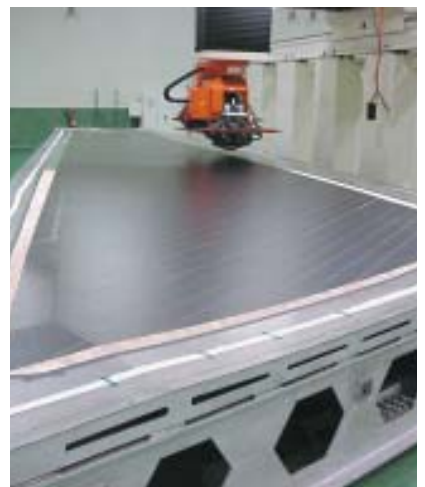
Eine Bandlegemaschine bei der Bearbeitung einer Höhenleitwerk-Außenhaut.
