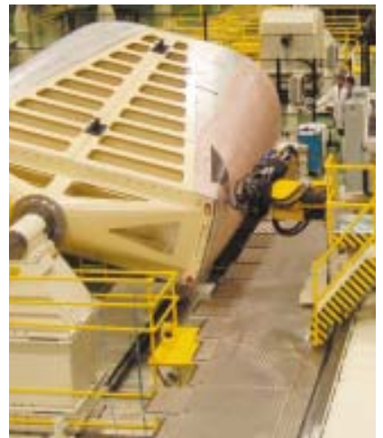
Auf einer Faserlegemaschine beginnt die Arbeit am A380-Rumpfabschnitt Sektion 19.1.
