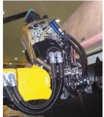
Detailansicht einer Faserlegemaschine im Advanced Composites Center, Illescas
