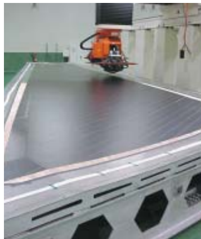
Une machine automatisée de drapage de nappes produit un plan fixe horizontal
