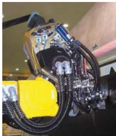
Détail d'une machine de dépose par placement de fibres dans l'usine d'Illescas.
