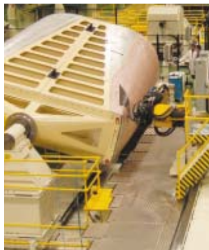
Début de la fabrication des parois d'un tronçon 19.1 de l'A380 par une machine de dépose par placement de fibres
