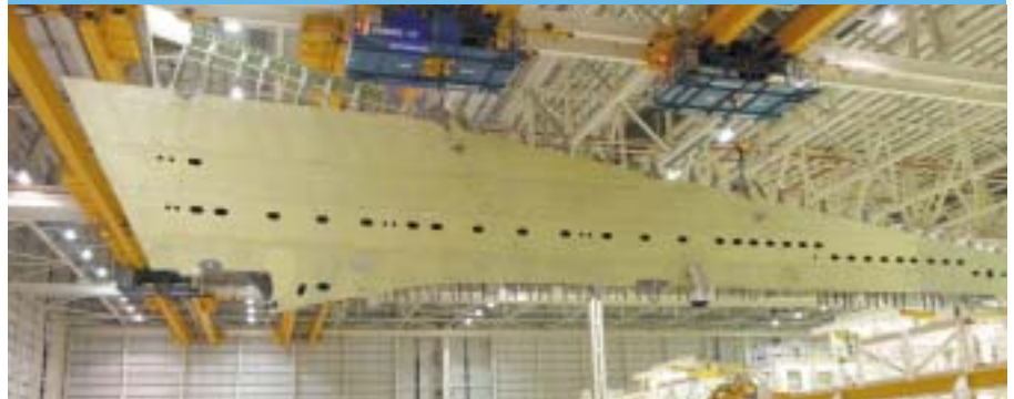
Mit 36,3 m Länge sind die A380-Flügel aus Broughton die größten, die je für ein Verkehrsflugzeug konstruiert wurden.
