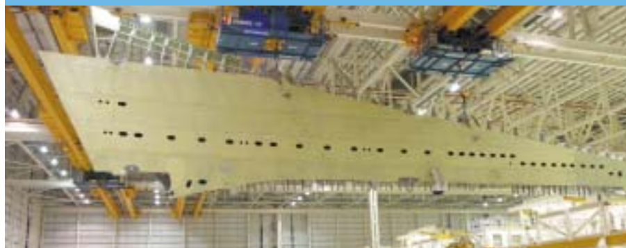
Avec 36,3 m de long, l'aile produite à Broughton en Grande-Bretagne est la plus grande jamais construite pour un avion commercial
