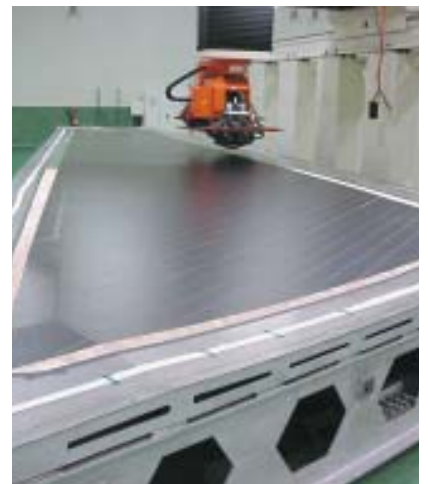
Una máquina de colocación automatizada de flejes trabajando en el forro del plano horizontal de la cola
