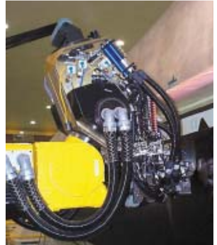
Detalle de la máquina de coacción de fibra en el Centro de Compuestos Avanzados de Illescas.
