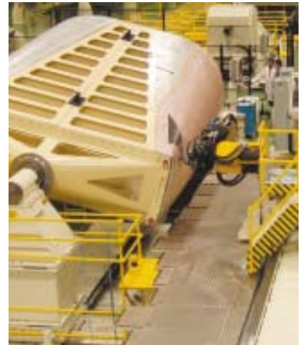
La máquina de colocación de fibra empezando a trabajar en la sección 19.1 del fuselaje del A380
