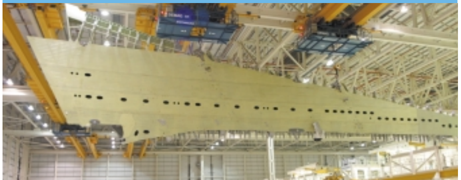
Con 36,3 m. de longitud, las alas producidas en Broughton (UK), son las mayores jamás diseñadas y construidas para un avión comercial.
