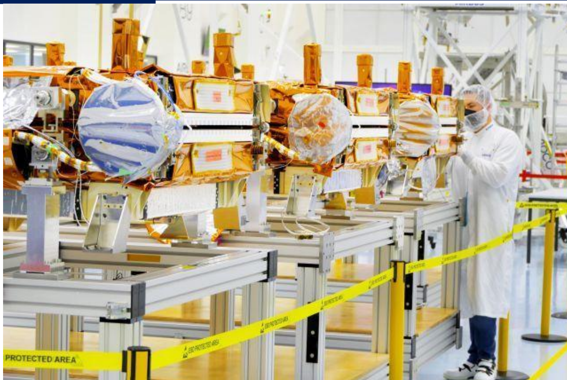
Segments d'antenne de Sentinel-1C - Copyright Airbus / Mathias Pikelj 2022 -
