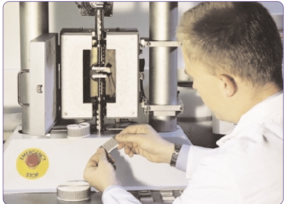
Ein Ingenieur prüft die Festigkeit eines Thermo-Klettverschlusses
